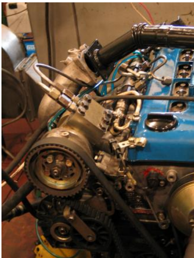
Рис.4. Установка ТНВД МГТУ на дизель ЗМЗ 514 в ОАО НИКТИД (г.Владимир).
