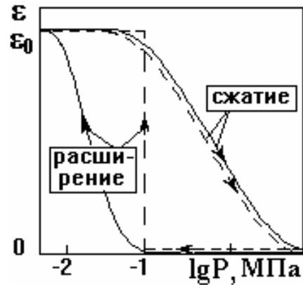
Рис.39. Гистерезис двухфазного состояния и его схематизация
