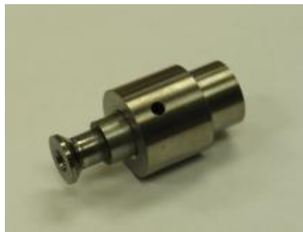
Рис. 1. Схема и конструкция разгруженного клапана ООО “ППП Дизельавтоматика”
